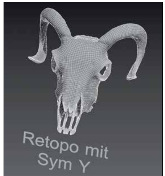
Die Symmetriefunktion ergibt ein sauberes Mesh, kann aber zu unerwarteten Ergebnissen führen, wenn das Original nicht absolut symmetrisch ist.
