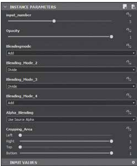
In den Einstellungen des Multiblend_Grayscale Node kann die Anzahl der Inputs und der jeweilige Blend Modus definiert werden.
