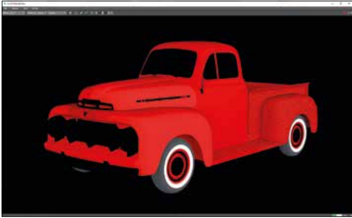
Im AOV Diffuse_direct ist die Qualität des Bildrauschens von der direkten Beleuchtung zu sehen.
